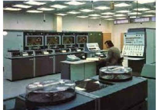
ES 1040 - Der eigentliche Computer (rechts angeschnitten) bestand meist aus 4 großen Schränken
